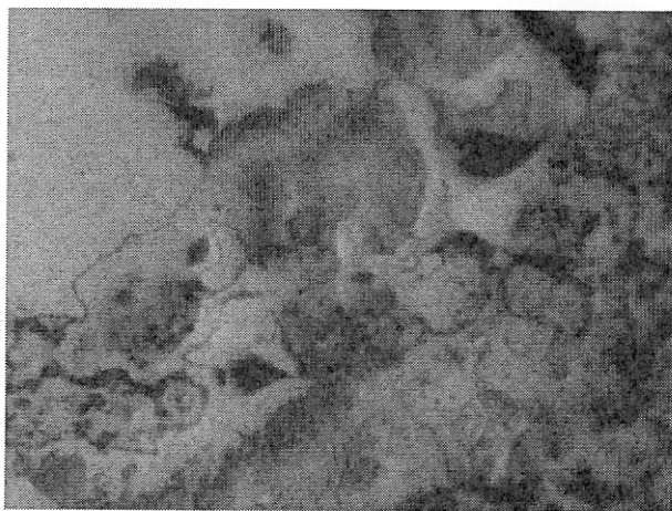
Figura 8 – Picral 4%. Aumento 400x. Sinterização 1120°C.
